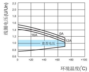
备注: 继电器使用过程中, 如果激励电压超过额定电压将会导致继电器电耐久性降低。在推荐电压范围内, 对电耐久性的影响会小一些。超过图中曲线规定的上限值, 继电器线圈的绝缘有可能会被损坏。
